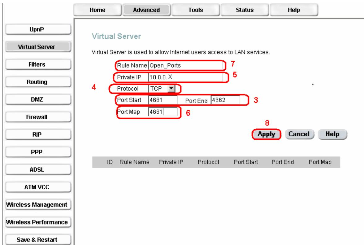
Una vez que se complete aplicación de la regla, aparecerá reflejada en la parte inferior de la pantalla (9). Guarde todos los cambios y reinicie el router (10).
