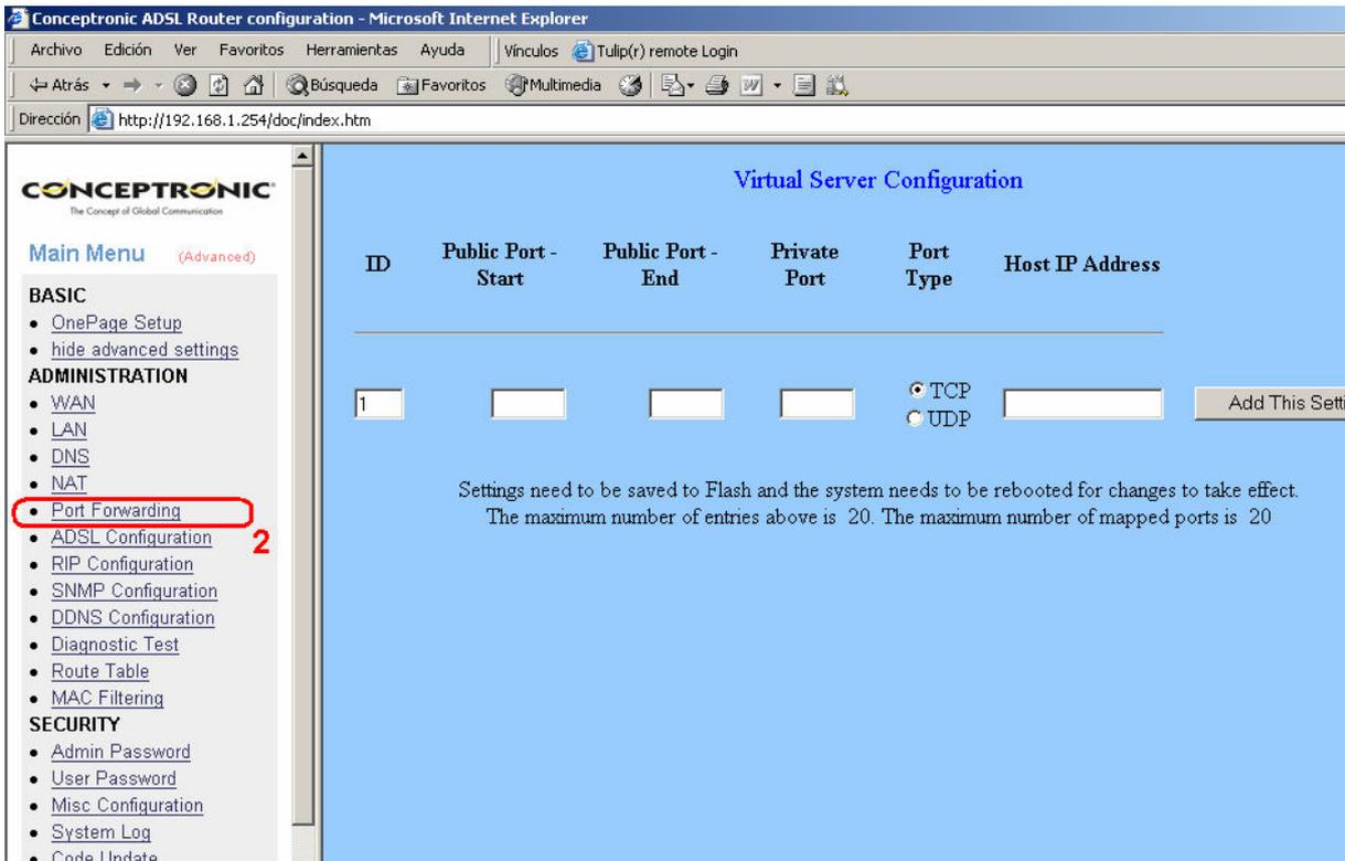
Introduzca el puerto o rango de puertos en los campos de la figura 3, seleccione el tipo de protocolo: TCP o UDP (figura 4), introduzca la IP del equipo del que quiere abrir los puertos (figura 5). Añada la nueva regla creada (figura 6), salve datos y reinicie el router (figura 7).
