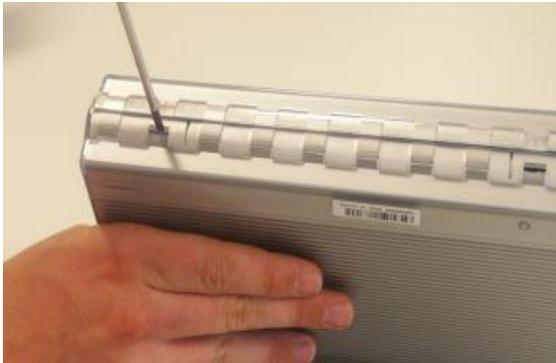
Presione hacia abajo cada una de las cuatro pestañas (dos en cada lado). Al presionar, la parte superior e inferior de la carcasa se separarán la una de la otra.
