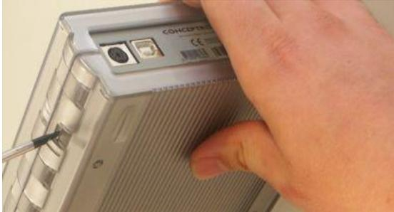
Por favor, utilice por ejemplo un destornillador o unas pinzas para abrir el CIDE525U. Haga presión para abrir el dispositivo.
