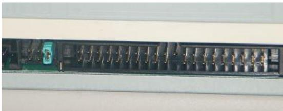
Por favor, tenga en cuenta que el jumper del dispositivo que va a conectar debe posicionarse en MASTER. Si está seleccionado SLAVE o CABLE SELECT el sistema no detectará el dispositivo (CD/RW, DVD/RW, HDD etc.)
