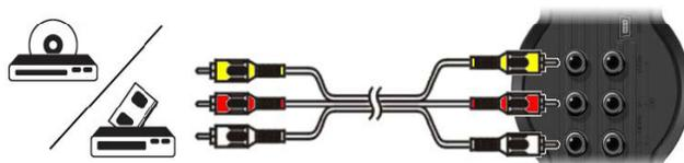
Conecte el otro lado del cable Composite a la salida de TV de su receptor TDT. Por favor consulte el manual de su receptor TDT para comprobar cómo y dónde debe conectar el cable de audio y video Composite. A continuación mostramos un ejemplo de cómo conectamos el otro extremo del cable Composite a un receptor TDT usando un adaptador de euroconector (SCART).
