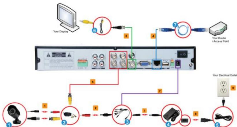
1. Conecte el conector BNC y el conector de alimentación de las cámaras CCTV (1) a los cables de la cámara (2).
