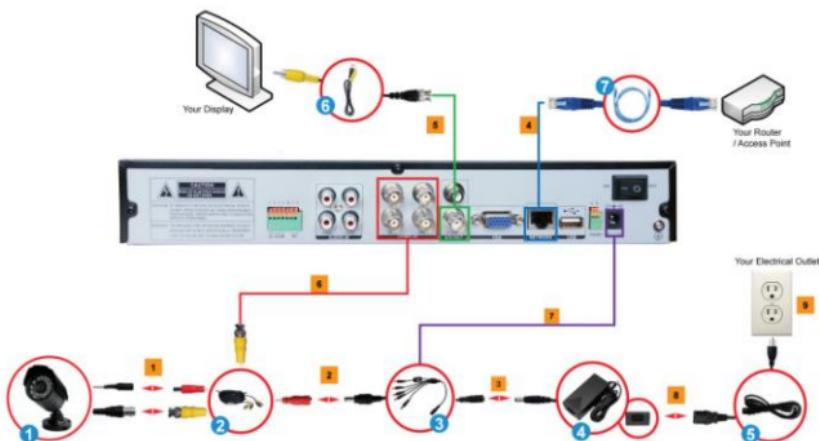
1. Подключите BNC-соединитель и разъем питания камеры видеонаблюдения (1) с помощью камерного кабеля (2).
