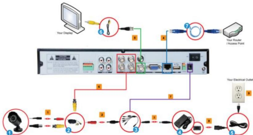
1. Sluit de BNC-connector en de voedingsconnector van de CCTV-camera's (1) aan met camerakabels (2).
