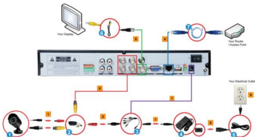
1. Reliez le connecteur BNC et le connecteur d'alimentation de la caméra CCTV (1) et les câbles de la caméra (2).
