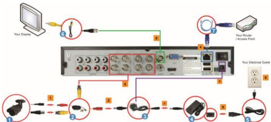
1. Ligue o conector BNC e o conector de alimentação das câmaras do circuito fechado de televisão (1) aos cabos das câmaras (2).
