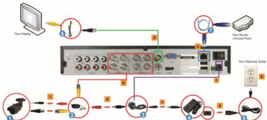
1. Reliez le connecteur BNC et le connecteur d'alimentation de la caméra CCTV
