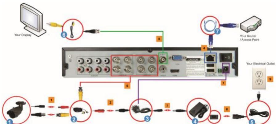
1. Conecte el conector BNC y el conector de alimentación de las cámaras CCTV
