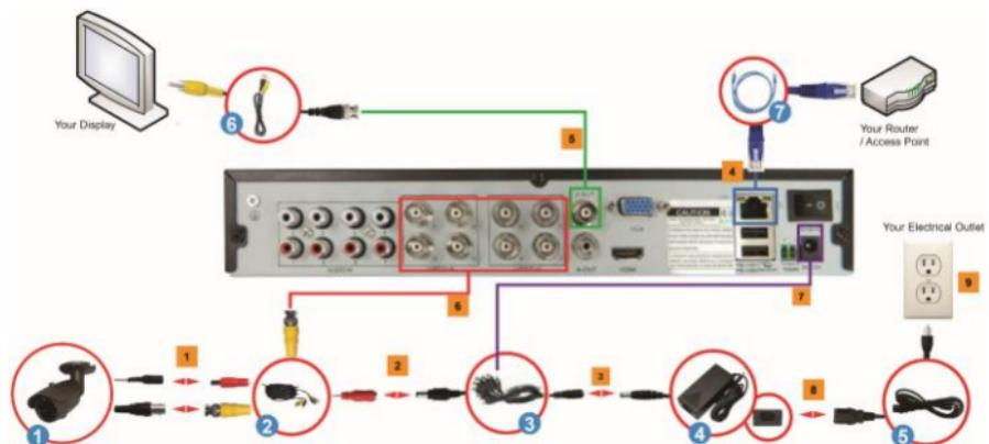
1. Verbinden Sie BNC- und Netzanschluss der CCTV-Kameras (1) mit den Kamerakabeln (2).
