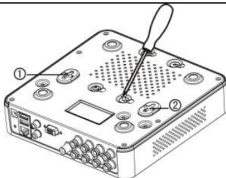
4) Volver a colocar la cubierta del DVR y apretar los tornillos.
