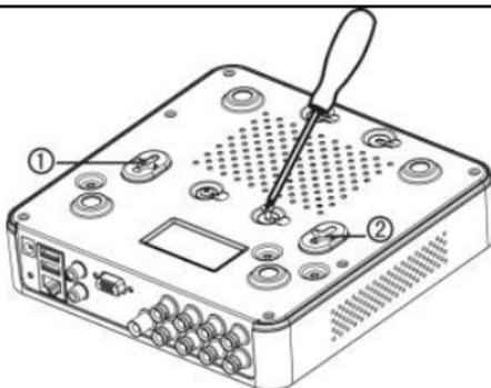
4) Zainstaluj ponownie pokrywę DVR i zamocuj śrubami.
