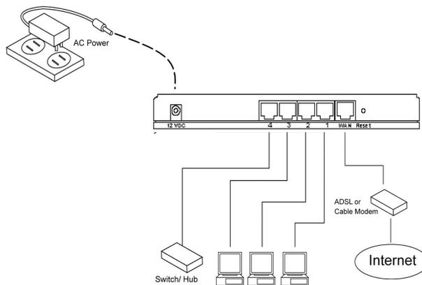
Branchez une extrémité du câble de réseau UTP à l'ordinateur et l'autre, au routeur.
