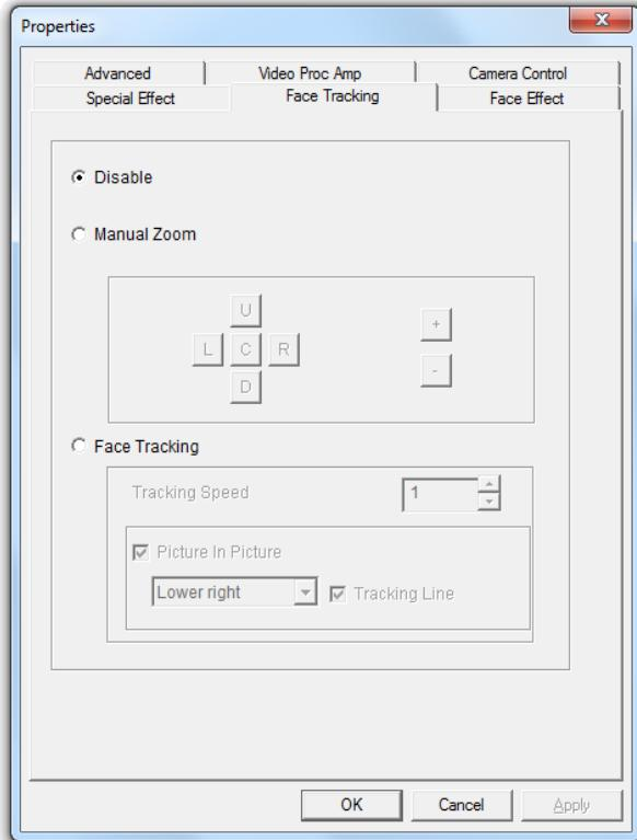
En la pestaña “**Face Tracking**”, podrá acercar o alejar manualmente la imagen de la cámara web, o utilizar la opción “**Face Tracking**” (Seguimiento de la cara) para que acerque automáticamente la imagen de su cara.
