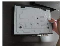
⑥ Festplattenschraube befestigen
