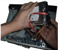
④ Netzkabel anschließen
