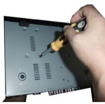
⑤ Festplattenschraube befestigen
