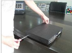
① Schrauben an beiden Seiten entfernen
